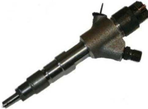
*Рис. 1.* Топливная форсунка трактора МТЗ-1221
