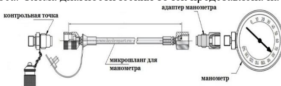
Рисунок 2 - Схема подключения манометра для диагностики гидросистемы JCB 250
