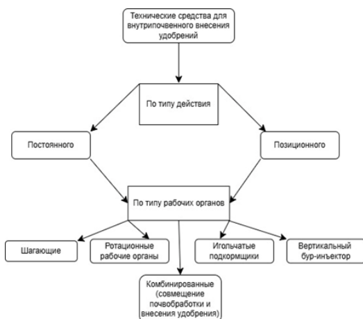
Рисунок 4 Классификация технических средств для внутрипочвенного внесения удобрений
