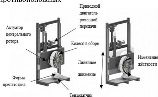
Рис. 4. Конфигурация (слева) и принцип работы (справа) испытательного стенда
