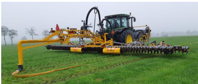
Рисунок 2 – Инжекторное (внутрипочвенное) внесение жидкого навоза в период вегетации
