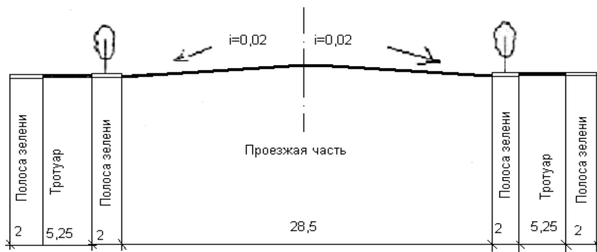
Рисунок 10 - Поперечный профиль улицы без полосы для разделения встречного движения
