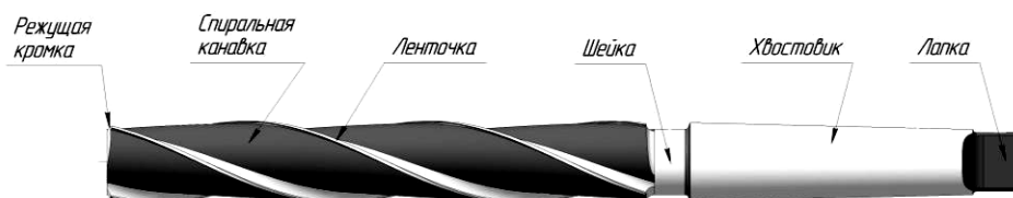
Рис.14 Конструкция хвостового зенкера
