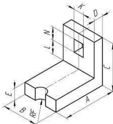
*Задание 12.:* Вы работаете в конструкторском бюро. При конструировании нового оборудования вам необходимо выполнить чертеж детали в одной из графических программ. Проставить размеры. Выполнить необходимые разрезы.
