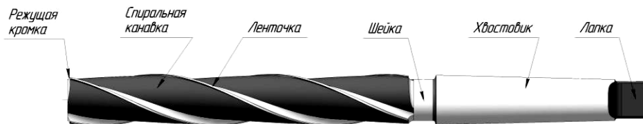
Рис.14 Конструкция хвостового зенкера
